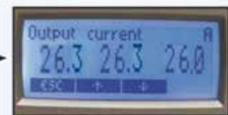
Mostrar corriente de salida del módulo individual
